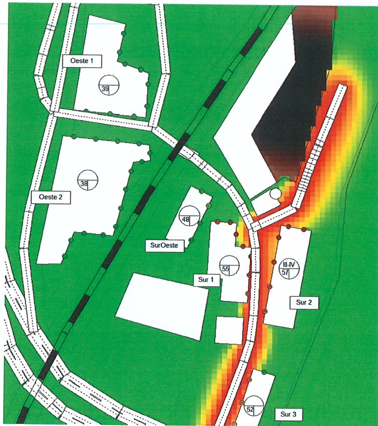
Figura 2. Niveles Ld en Escenario 4.1. (Fuente máximo de 103 dB, localizada en zona central de planta) Detalle en planta (Superación de límites en planta III y IV de edificio sur 2).
